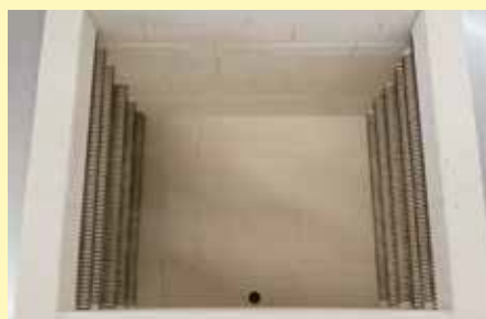
Varmelegemer på bærerør sørger for fri varmeudstråling
