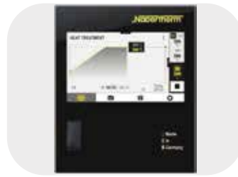
Controller med touchbetjening C540 med i alt 10 programmer, hver med 20 segmenter
